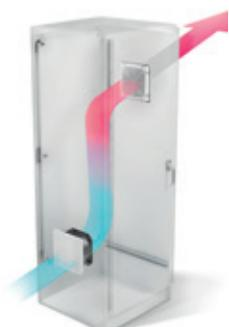
Принудительная конвекция - это недорогое и эффективное решение, предотвращающее образование воздушных тепловых карманов внутри электрошкафов. Лучшая конфигурация состоит из вентилятора фильтрующего на входе в нижней части и решетки с фильтром на выходе в верхней части электрошкафа.
