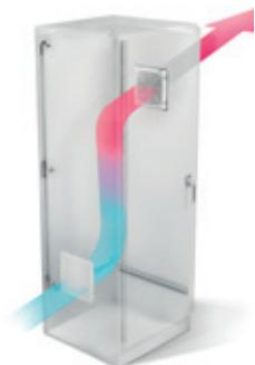
При использовании двух решеток с фильтром, обеспечивается приток наружного воздуха в нижнюю часть и удаление тепла естественным образом из верхней части электрошкафа. Это решение экономично и применимо для рассеивания низкого уровня тепла в пыльной среде.
