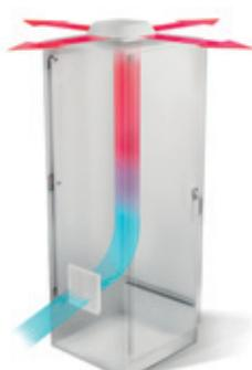
При отсутствии возможности установки вентиляторов фильтрующих на дверь и боковые стенки, рекомендуется воспользоваться вентилятором фильтрующим для установки на крышу электрошкафа. Установка решетки с фильтром в нижней части электрошкафа обеспечит отличную конвекцию.
