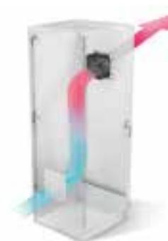
Так же возможна установка вентилятора фильтрующего в верхней части электрошкафа, а решетки с фильтром в нижней части, но эффективность очистки воздуха и ресурс вентилятора снижаются.
