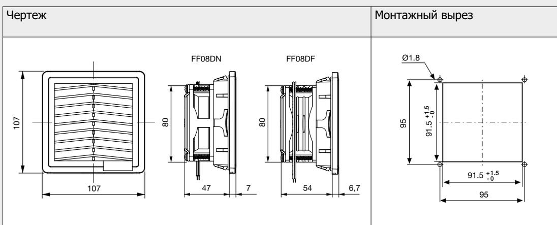
Прямой поток / Обратный поток FF08DN
