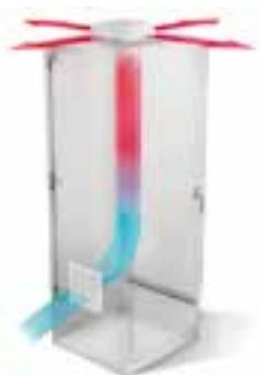
При отсутствии возможности установки вентиляторов фильтрующих на дверь и боковые стенки, рекомендуется воспользоваться вентилятором фильтрующим для установки на крышу электрошкафа. Установка решетки с фильтром в нижней части электрошкафа обеспечит отличную конвекцию.
